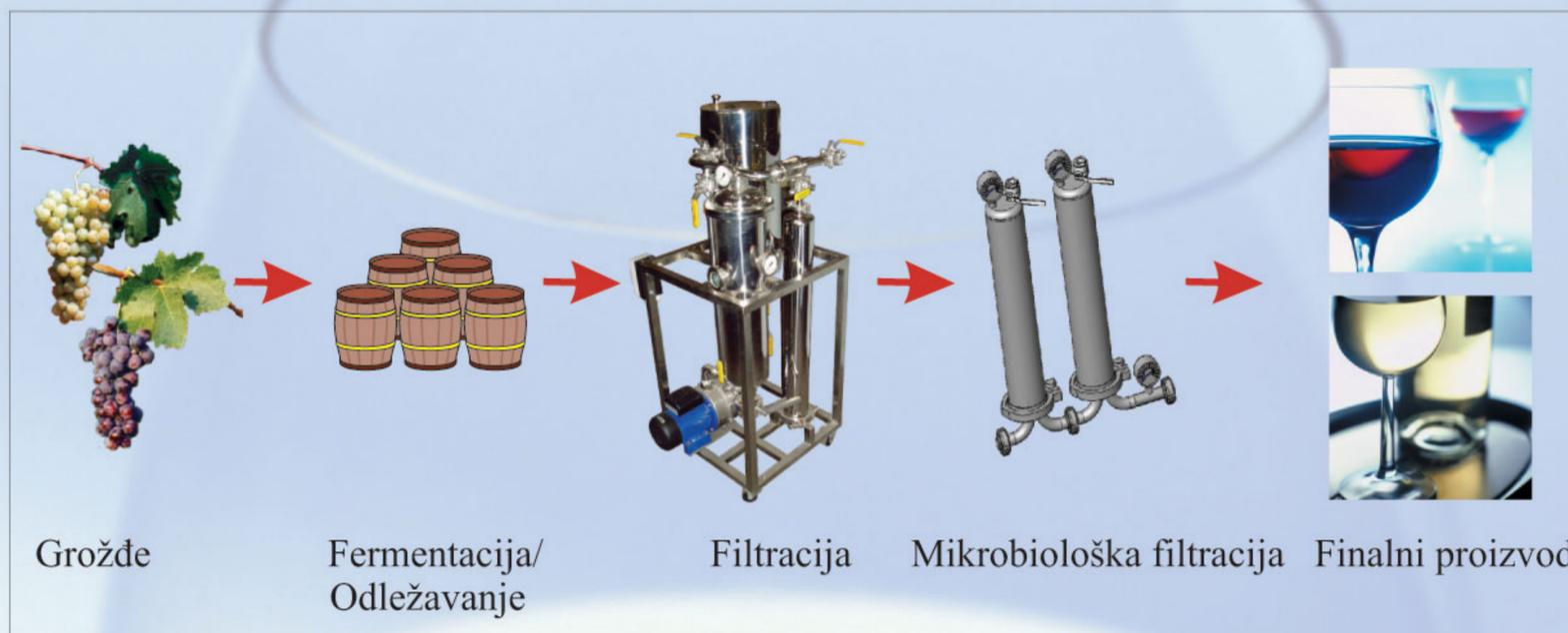
Stalni zahtevi za postizanjem visokog kvaliteta proizvoda s jedne strane i nastojanja da se snize troškovi i povećaju kapaciteti proizvodnje s druge, doveli su do razvoja i praktične primene novih sistema u svim fazama tehnološkog procesa proizvodnje vina. Umesto klasičnih ramskih filtera sa pločama (slojnicama) sada se uglavnom koriste naplavni filteri sa filterskim svećama. Prednosti korišćenja naplavnih filtera sa filterskim svećama su:
